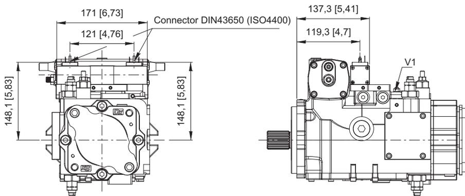
V1: strozzatore variabile / Adjustable throttle valve
