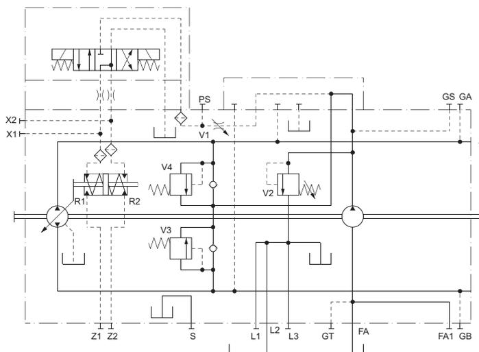
**Direzione del flusso:** Correlazione tra il senso di rotazione della pompa (visto dal lato albero) e l'azionamento del regolatore.
