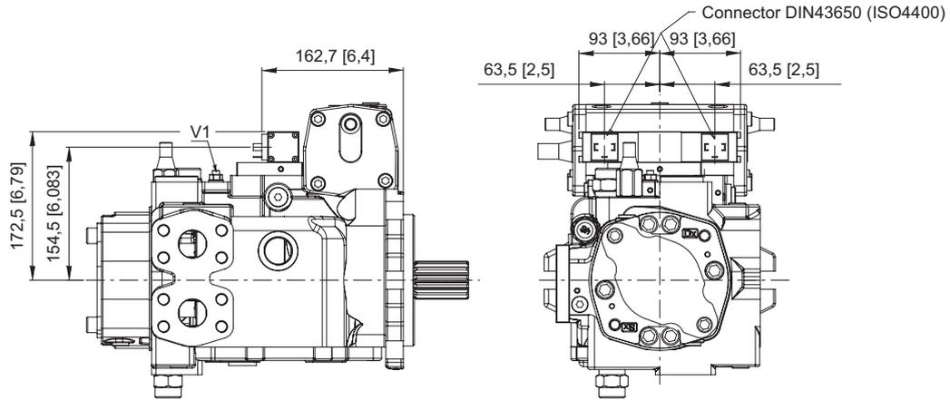
V1: strozzatore variabile / Adjustable throttle valve
