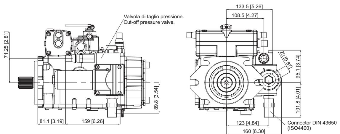
**Filtro + Taglio elettrico + compensatore di pressione (EP)**
