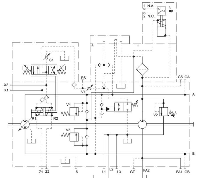
Sensore elettrico / Electrical sensor (E1-E2-E3-E9)
