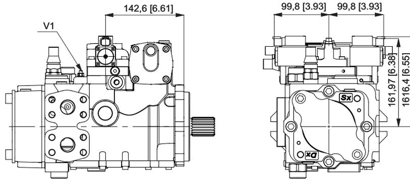
V1: strozzatore variabile / Adjustable throttle valve
