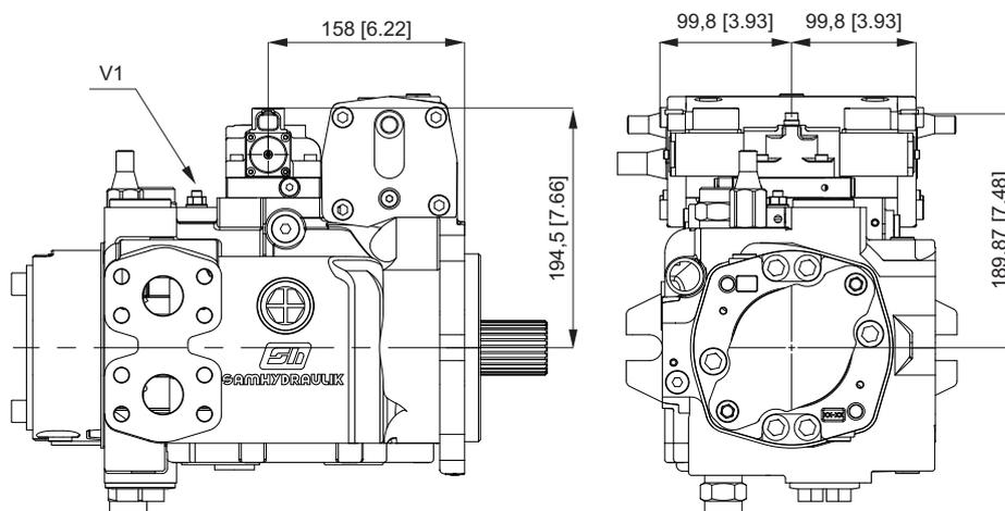
V1: strozzatore variabile / Adjustable throttle valve
