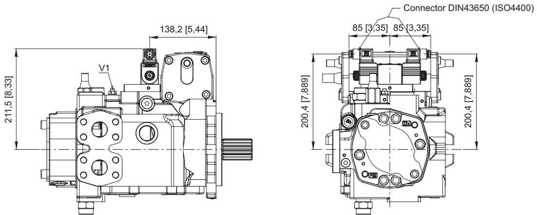
V1: strozzatore variabile / Adjustable throttle valve
