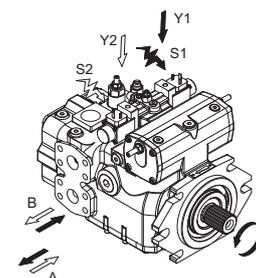
Il comando "AUTOMOTIVE" è tipicamente usato in trasmissioni idrostatiche con pompe in circuito chiuso.
