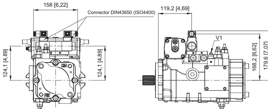
V1: strozzatore variabile / Adjustable throttle valve
